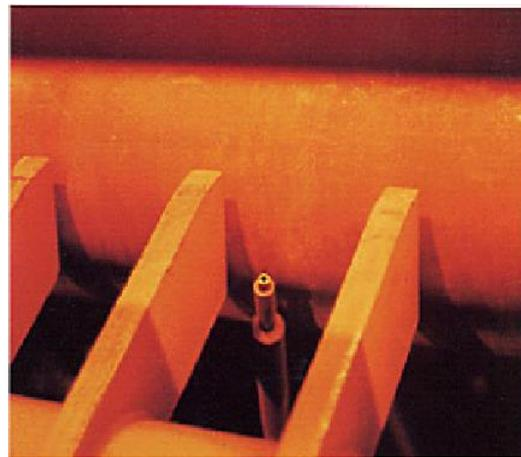
安装在热轧板材生产线辊道的导板上
