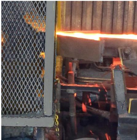
安装在热轧带钢生产线辊道平面下方
