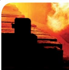
Стандартные операции при загрузке слябов в высокотемпературную печь включают в себя детектирование, позиционирование и измерение параметров сляба. Сенсоры DELTA способны работать даже на очень неровных поверхностях слябов, в обстановке сильной вибрации и высокой температуры, которая сопровождает процесс загрузки слябов в печь. Также DELTA разработала ряд уникальных сенсоров для детектирования плит внутри высокотемпературной печи и на выгрузке.
