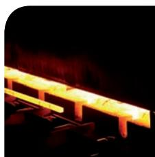
La carica di un forno è un'operazione critica. E' necessario conoscere la lunghezza e la posizione della billette o del blumo prima dell'informamento. Per lo sfornamento, è egualmente importante rilevare il materiale per conoscere la sua posizione e verificare che non si sia messo di traverso.
