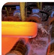
Dall'uscita del forno fino agli aspi, i sensori DELTA (rilevatori di materiale caldo, rilevatori di infrarossi e misuratori di distanza) vengono utilizzati per il rilevamento, il posizionamento dei bordi, e la misura dimensionale. Essi operano in modo preciso ed affidabile nelle condizioni difficili dei laminatoi a caldo : temperatura ambiente elevata, irraggiamento importante, vapore, spruzzi d'acqua, polveri...
