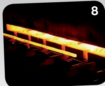
Nachwärmofen für Knüppel und Blöcke
